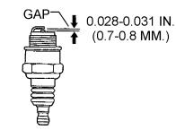
Figure 18. Spark Plug Gap
